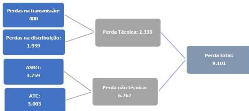
Figura 12 – Perdas de Energia
